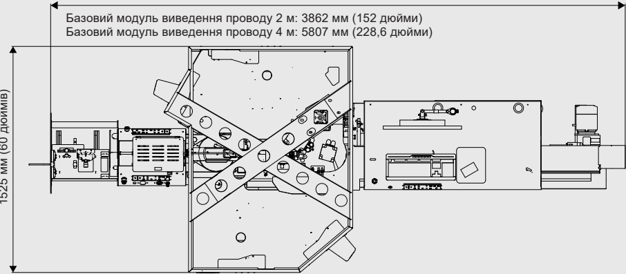
Висота при закритій кришці: 1790 мм (70,5 дюйма) Висота при повністю відкритій кришці (максимальне відкриття): 2790 мм (109,8 дюйма)
