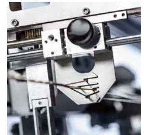
Опція високоточного скручування кількох проводів.
