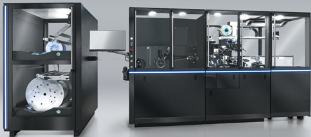
▲ Конфігурація Optima 600 із двошпульним розмотувачем та модулями WCT, WSI і WEL
